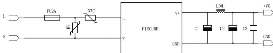
(注：输出滤波电容 C1.C2 为电解电容，建议使用高频低阻电解电容，容量和流过的电流请参考各厂商提供的技术规格。电容耐压降额大于 80%。C3 为陶瓷电容，去除高频噪声。 推荐外接 NTC 热敏电阻，型号:10D-11。推荐外接 MOV 压敏电阻。)
